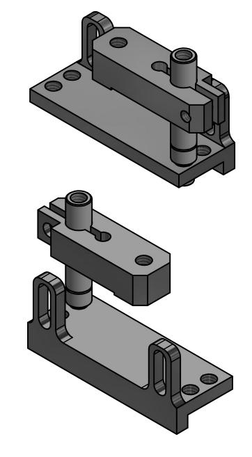
Зажим для крепления призмы монтируется на компоненты каркасной системы, для этого предусмотрены пазы для винтов МЗ. Призма фиксируется винтом М4 с пластиковым наконечником.
